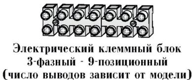
Электрический клеммный блок 3-фазный - 9-позиционный (число выводов зависит от модели)
