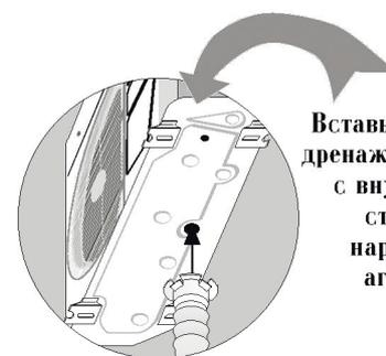
Вставьте штуцер дренажной трубки с внутренней стороны наружного агрегата
